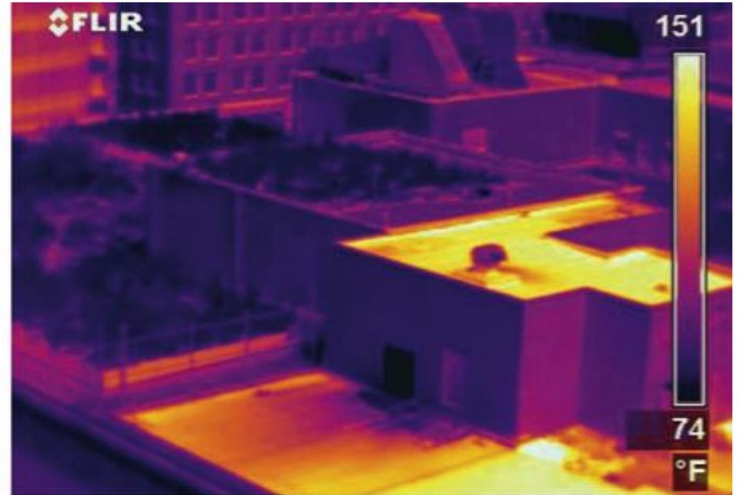
*Foto di un tetto con copertura verde e rivestimento in materiale riflettente, a confronto con un profilo termografico a confronto*
